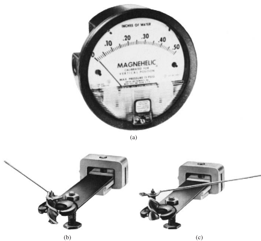
FIGURA 3.16 Medidor magnético de presión. (Fuente: Dwyer Instruments, Inc., Michigan City, IN.)
