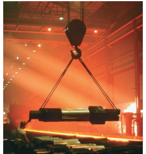
Fotografía 2.1 Como se ilustró en un ejemplo anterior, es posible determinar las tensiones en los cables que sostienen al eje que se muestra en la fotografía, considerando al gancho como una partícula y después aplicando las ecuaciones de equilibrio a las fuerzas que actúan sobre el gancho.
