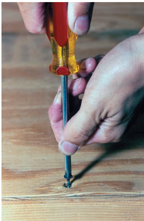
Fotografía 3.5 La acción de empujar y girar, asociadas con la operación de apretar un tornillo ilustra las líneas de acción colineales de la fuerza y el vector de par que constituyen una llave de torsión o torsor.
