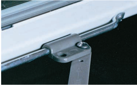
Fotografía 4.3 Cuando el eslabón del mecanismo de apertura del toldo para ventana se extiende, la fuerza que éste ejerce sobre el deslizador produce una fuerza normal aplicada sobre la barra, lo que causa que el toldo se abra.
