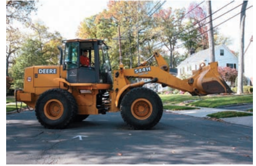
Fotografía 4.1 Un diagrama de cuerpo libre del tractor que se muestra en la foto incluiría todas las fuerzas externas que actúan sobre él: el peso del tractor, el peso de la carga en la pala y las fuerzas ejercidas por el suelo sobre las llantas.
