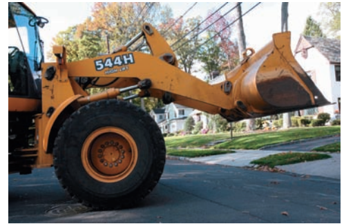
Fotografía 4.2 En el capítulo 6 se expondrá cómo determinar las fuerzas internas en estructuras hechas de varias piezas conectadas, como las fuerzas en los elementos que soportan la pala del tractor de la fotografía 4.1.
