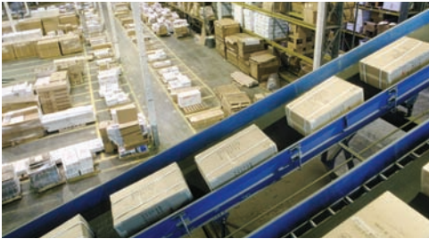
Fotografía 8.1 El coeficiente de fricción estática entre un paquete y la banda transportadora inclinada debe ser lo suficientemente grande para permitir que los paquetes sean transportados sin resbalar.
