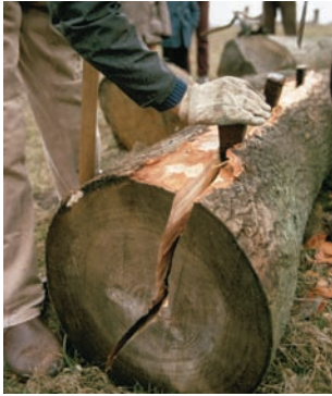
Fotografía 8.2 Como se muestra en la fotografía, las cuñas se emplean para partir troncos de árbol porque las fuerzas normales ejercidas por las cuñas sobre la madera son mucho más grandes que las fuerzas requeridas para insertarlas en el tronco.
