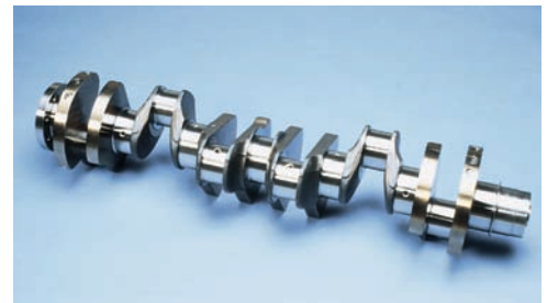
Fotografía 9.2 Como se expondrá en el curso de dinámica, el comportamiento rotacional del eje que se muestra en la fotografía depende del momento de inercia de masa del eje con respecto a su eje de rotación.
