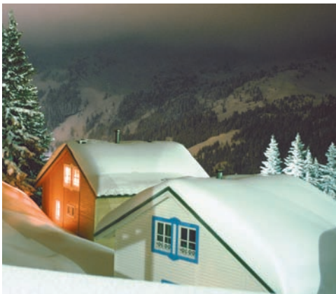
Fotografía 5.3 Los techos de las construcciones que se muestran en la fotografía pueden ser capaces de soportar no sólo el peso de la nieve, sino también las cargas distribuidas no simétricas causadas por el amontonamiento de la nieve.
