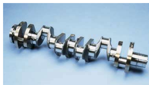
Fotografía 9.2 Como se expondrá en el curso de dinámica, el comportamiento rotacional del eje que se muestra en la fotografía depende del momento de inercia de masa del eje con respecto a su eje de rotación.
