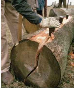
Fotografía 8.2 Como se muestra en la fotografía, las cuñas se emplean para partir troncos de árbol porque las fuerzas normales ejercidas por las cuñas sobre la madera son mucho más grandes que las fuerzas requeridas para insertarlas en el tronco.
