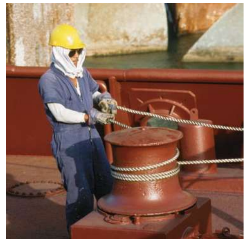
Fotografía 8.3 Al enrollar la cuerda alrededor del bolarde, la fuerza ejercida por el trabajador para controlar la cuerda es menor que la tensión en la porción tirante de la cuerda.
