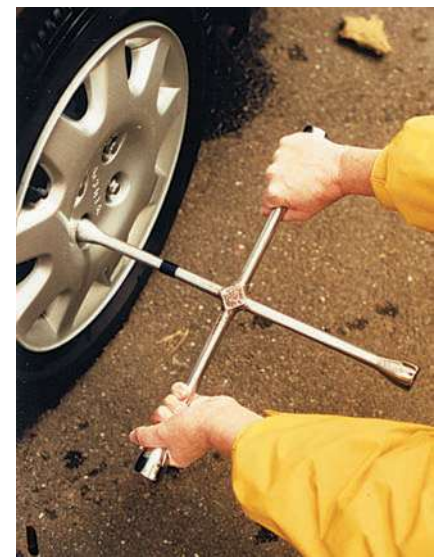
Fotografía 3.1 Las fuerzas paralelas de igual magnitud ejercidas hacia arriba y hacia abajo sobre los brazos de la cruceta, son ejemplo de un par.
