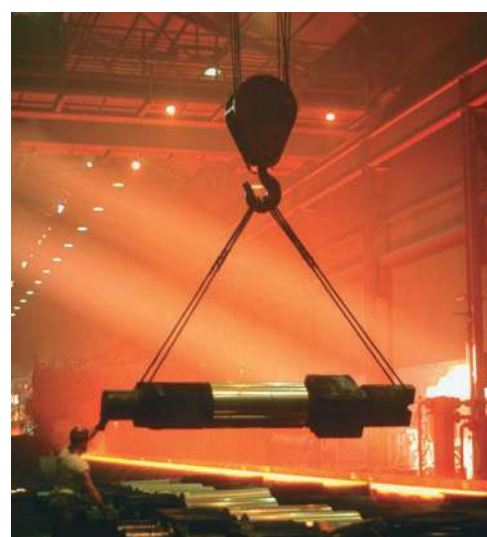
Fotografía 2.1 Como se ilustró en un ejemplo anterior, es posible determinar las tensiones en los cables que sostienen al eje que se muestra en la fotografía, considerando al gancho como una partícula y después aplicando las ecuaciones de equilibrio a las fuerzas que actúan sobre el gancho.
