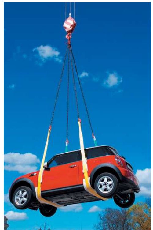
Fotografía 2.2 Como la tensión presente en los cuatro cables que sostienen al automóvil de carga no se puede encontrar mediante las tres ecuaciones (2.34), es posible obtener una relación entre las tensiones considerando el equilibrio del gancho.
