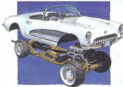
Figura 6.26 El bastidor de un automóvil (a) y el esqueleto de una persona (b) no son armaduras.
